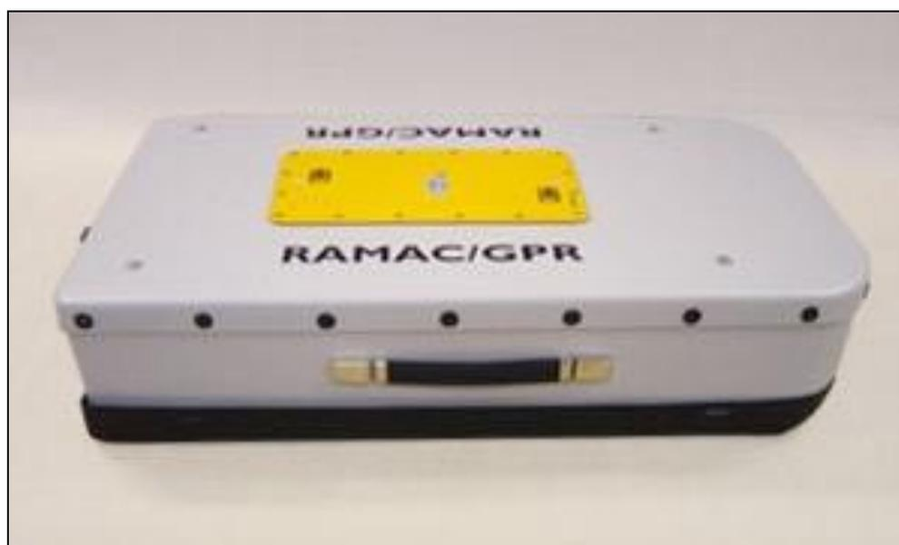
Figura 5. Antena blindada de 250MHz do sistema Ramac/GPR.
